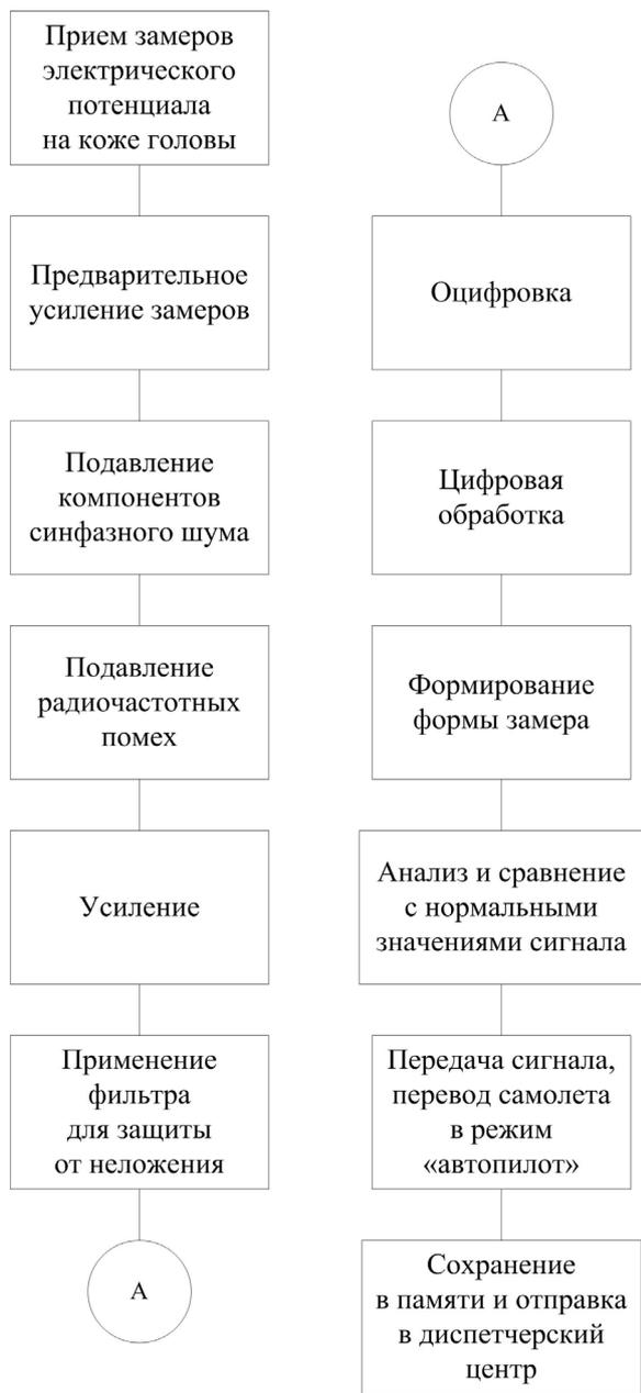
Рис. 3. Предложенный алгоритм обработки ЭЭС
