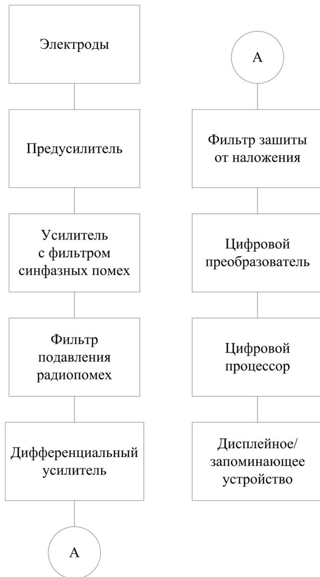
Рис. 2. Блока-схема известного устройства измерения информативных параметров ЭЭС
