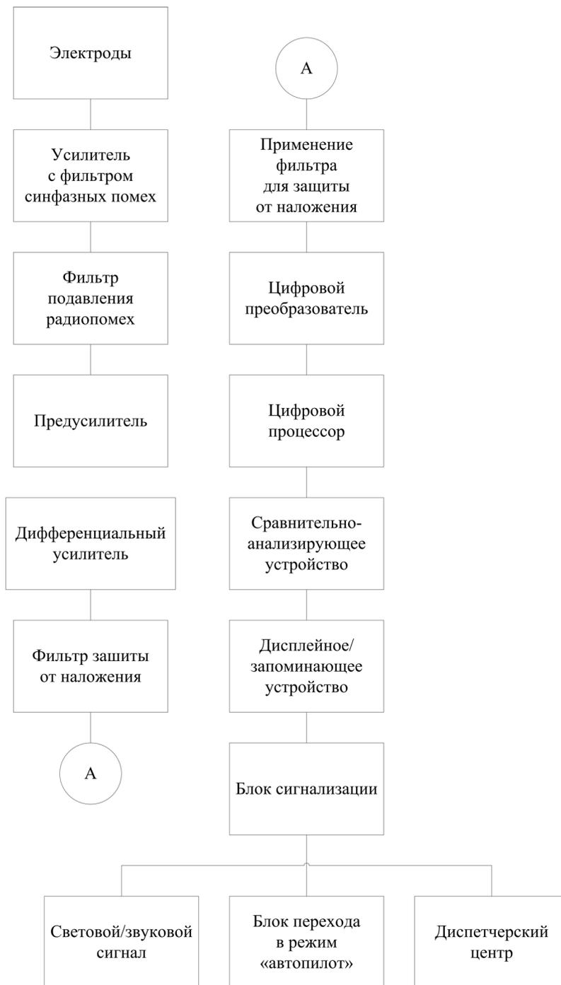
Рис. 4. Блок-схема предложенного устройства измерения информативных параметров ЭЭС
